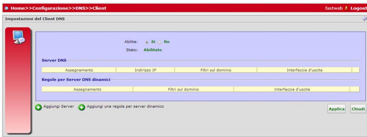
FIGURA 21. Pannello DNS Client e Relay – Aggiungere un Server
