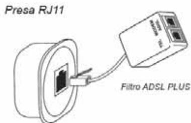
Inserisci una delle estremità del cavo ADSL nella porta ADSL del filtro e l'altra estremità nella porta DSL del Modem Router.
